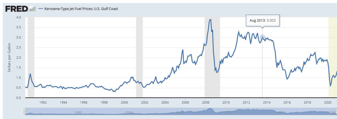
Figur 21: Historiske priser på flybrændstof. Før krakket i oliepriser i slutningen af 2014 var prisen 3 $/gal, svarende til 6.000 kr./ton.
